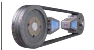
图4 激光单元装到皮带轮槽的示意图
