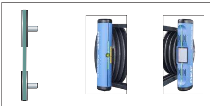
Рисунок 9 Соосность шкивов после правильно выполненной выверки
