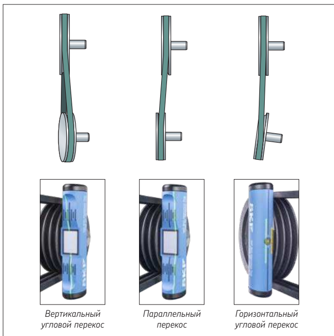
Рисунок 5 Определение типа перекося
