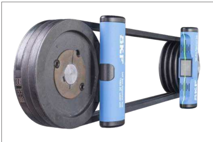
Рисунок 4 Блоки, установленные на шкивы
