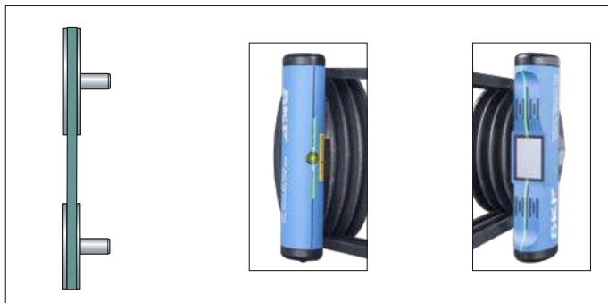
Figura 9 Polias perfeitamente alinhadas
