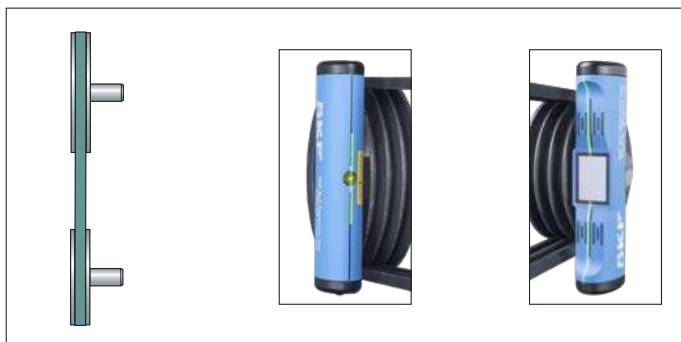
Figure 9 Pulegge perfettamente allineate
