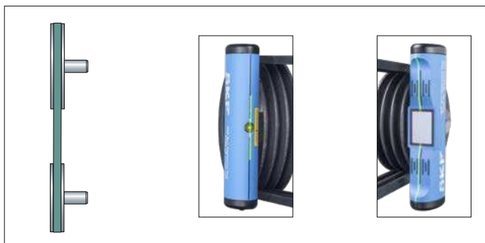
Abbildung 9 Perfekt ausgerichtete Riemenscheiben
